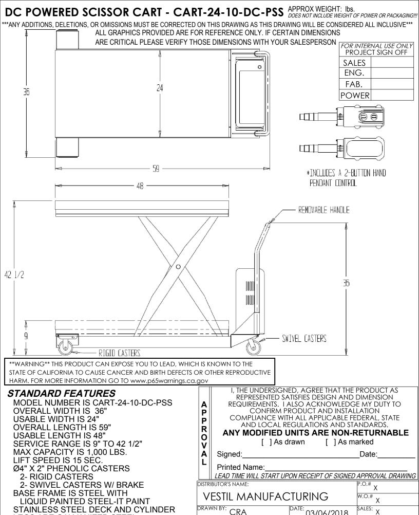
LEGS ARE GALVANIZED STEEL SPECIAL FEATURES NONE
